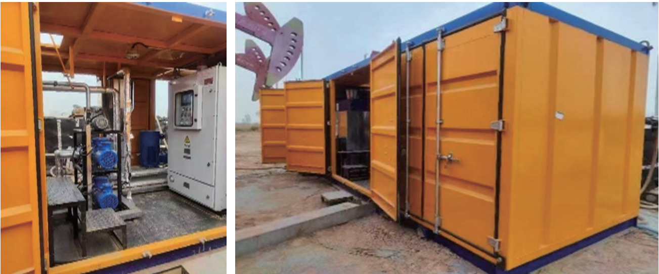
自主研发的柔性颗粒制备设备
